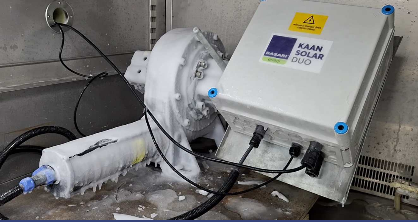
TCU ve Motor Dişli Sistemi Düşük Sıcaklık Çalışma Testi
